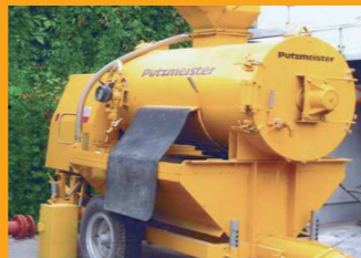
圖一、為泡沫製作槽和筒狀水泥攪拌機
