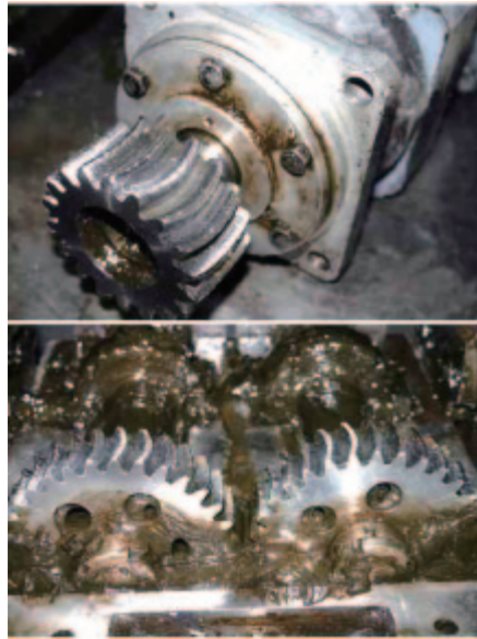
圖5：使用兩年的彎齒輪磨損狀
