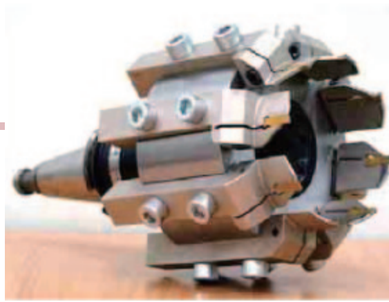
圖4：心軸上的刀頭
