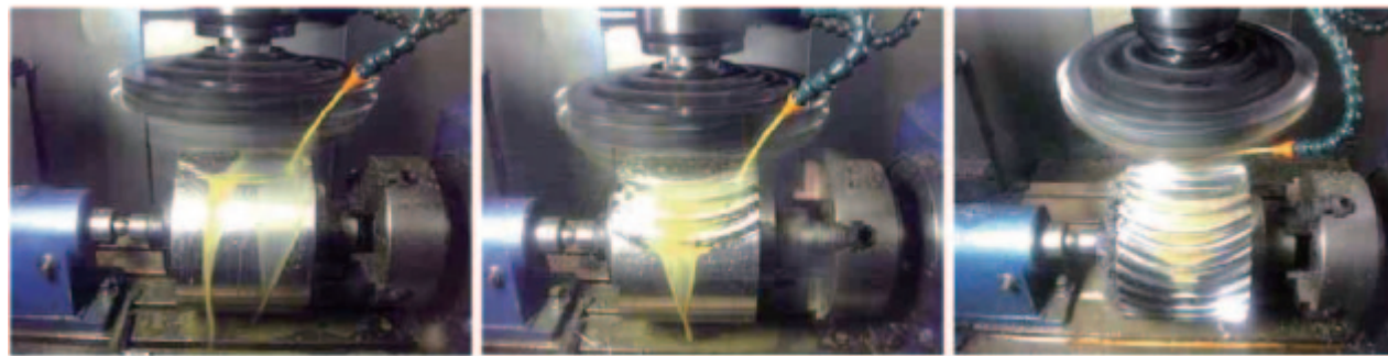
圖6：模數8.333的齒輪製造片段
