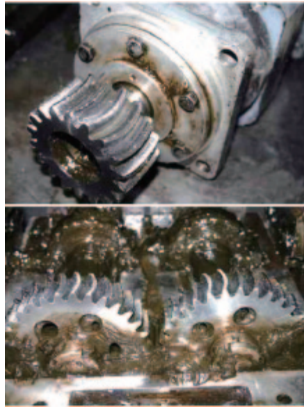
圖5：使用兩年的彎齒輪磨損狀
